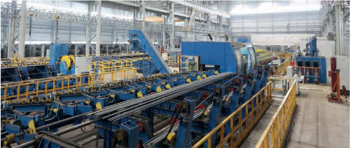
При повышенных требованиях к наружной поверхности и точности геометрических размеров прутка на новом прокатном стане имеется комплекс оборудования для обточки и полировки поверхности прокатной продукции. Данный комплекс включает в себя следующее оборудование: станок для обточки, двухвалковая правильно-полировальная машина.
